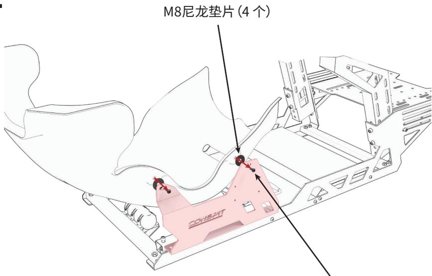
使用刚刚拧下的 4 颗螺栓将座椅与固定板连接
