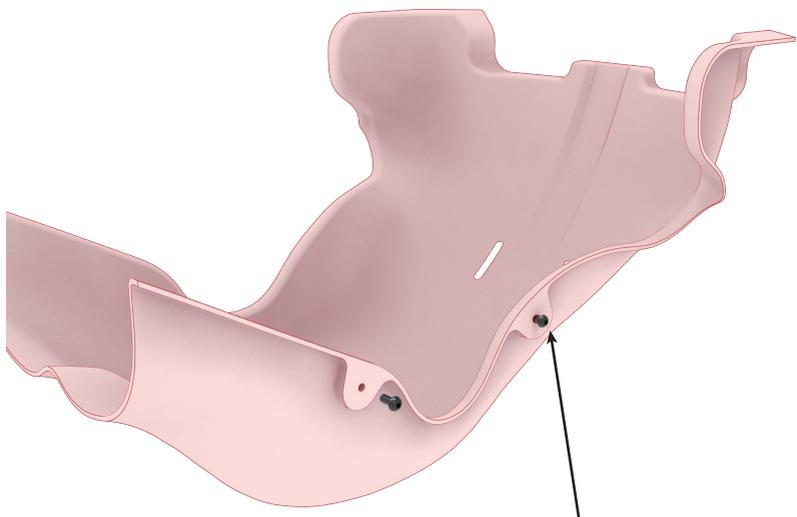
将座椅固定孔上的4颗 M8\*16mm 杯头螺栓拧下
